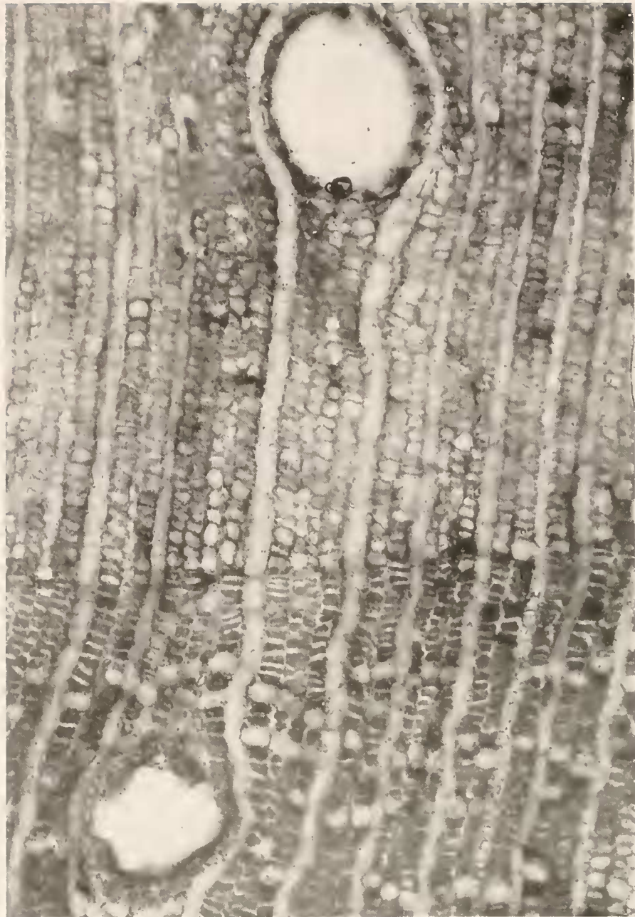
Abb. 5. Querschliff (BSP 1973 I 200). Zuwachsgrenze, Holzfasern in 1-5 radialen Reihen zwischen einreihigen Holzstrahlen; die im Spätholz hellen Parenchymzellen in tangential verstreuten Mustern. x 70.
